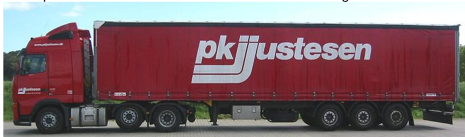
Figur 5 Sættevognstog med 6 aksler (3-3)
