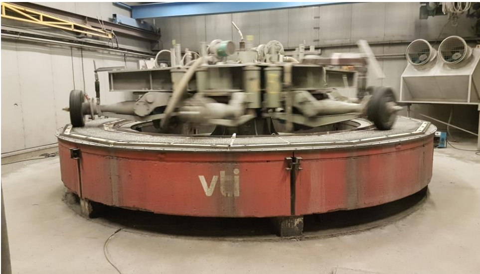
Figur 2, Accelererede belastningsforsøg på VTI i Sverige
