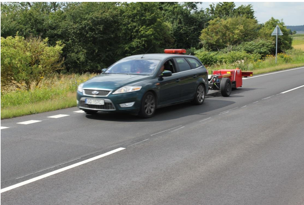
Figur 3, Måling af vejbelægningens rullemodstand, udført af det Tekniske Universitet i G'dansk
