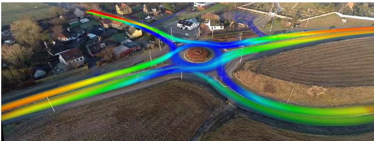
Figur 1 Eksempel på visualisering af hastigheder for personbiler i en rundkørsel.
