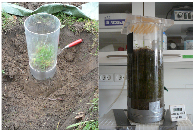
Figur 2. Udgravning af jordkolonne samt forsøgsopstilling i laboratoriet.
