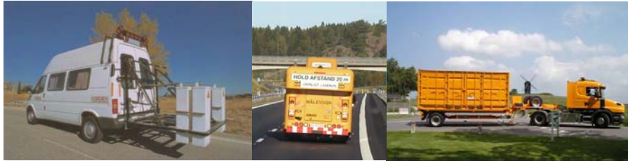
Figur 1. Udstyr til objektiv måling af belægningstilstand (fra venstre: Georadar – CEDEX, Spanien, ARAN-bil, Vejdirektoratet, High Speed Deflectograph, Vejdirektoratet).
