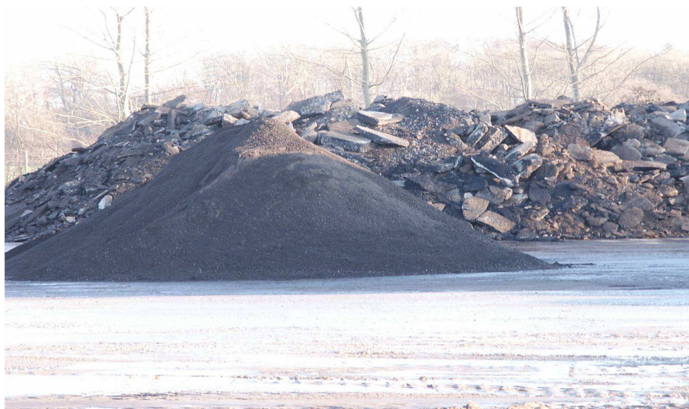
Figur 1. Genbrugsasfalt, indleveret på asfaltfabrikkerne, er en blanding af forskellige asfalttyper. I forgrunden ses en stak med knust asfalt. Efter knusning og opstakning er materialet meget homogent.
