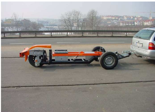
Rullemodstandsmåling med måletrailer fra TU Gdansk
