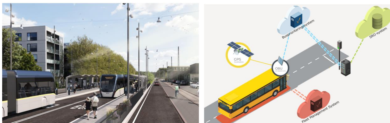
Figur 1 Illustration af Plusbus på Jyllandsgade i eget tracé (tv.) samt systemstruktur af busprioriteringssystemet (th.)
