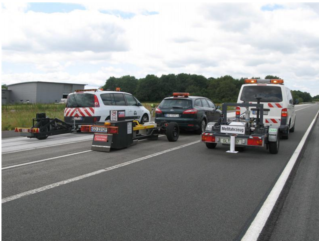
Figur 6 De tre måleudstyr som eksisterer i dag (fra venstre: BRRC i Belgien, TUG Polen og Bast i Tyskland)
