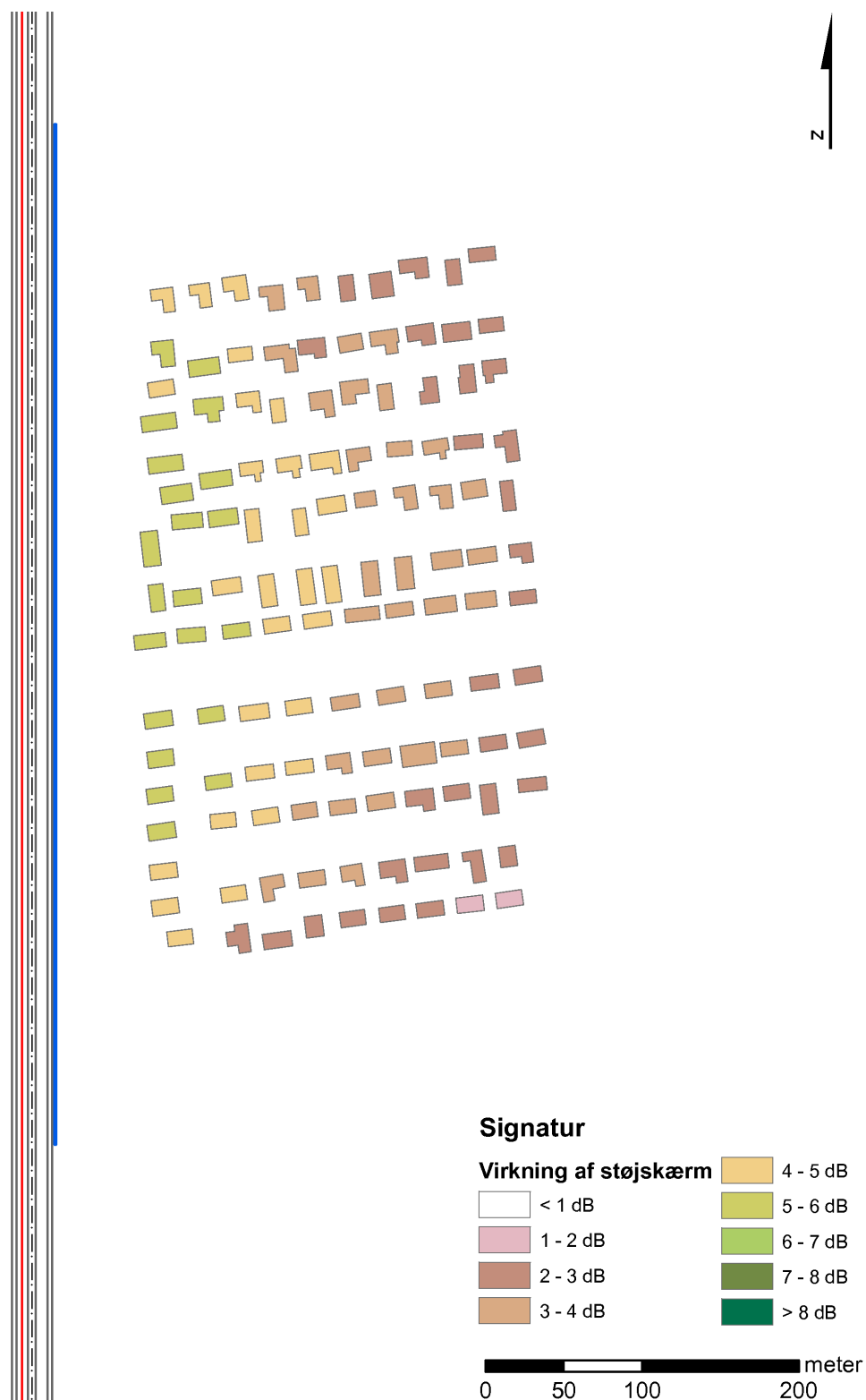
Figur 7: Støjskærmens virkning ved boligernes 1. sal er vist med en farvekode. Skærmen er 4 m høj med 60° afslutningsvinkler. De yderste boliger afskærmes mindre end boligerne inde i området. Flere eksempler kan ses i en "viewer" på Vejdirektoratets hjemmeside [4]
