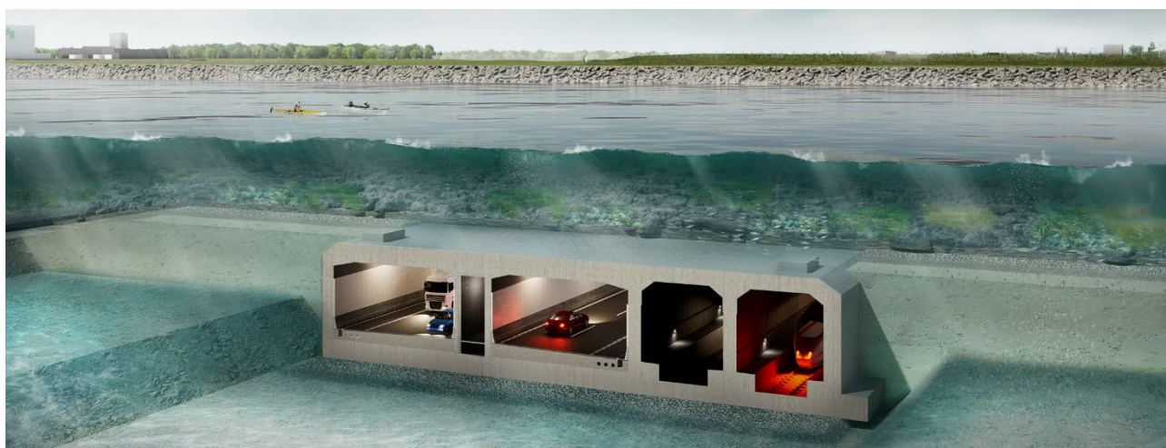
Illustration af den færdige sænketunnel med to vejror adskilt af et servicerør og to togrør.
