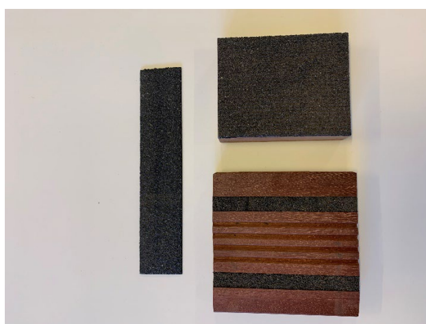
Fig. 3: Eksempler på skridsikring på træbroer.
